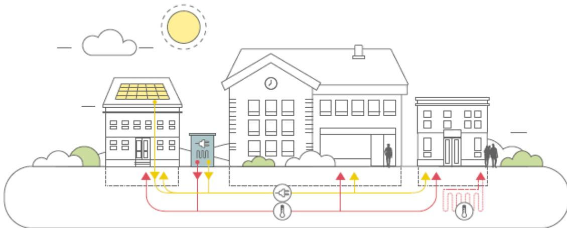
Abbildung 29: Schema einer gemeinsamen Wärme- und Stromversorgung in der Nähe eines Gebäudes mit hohem Energiebedarf (Quelle: OCF Consulting)
